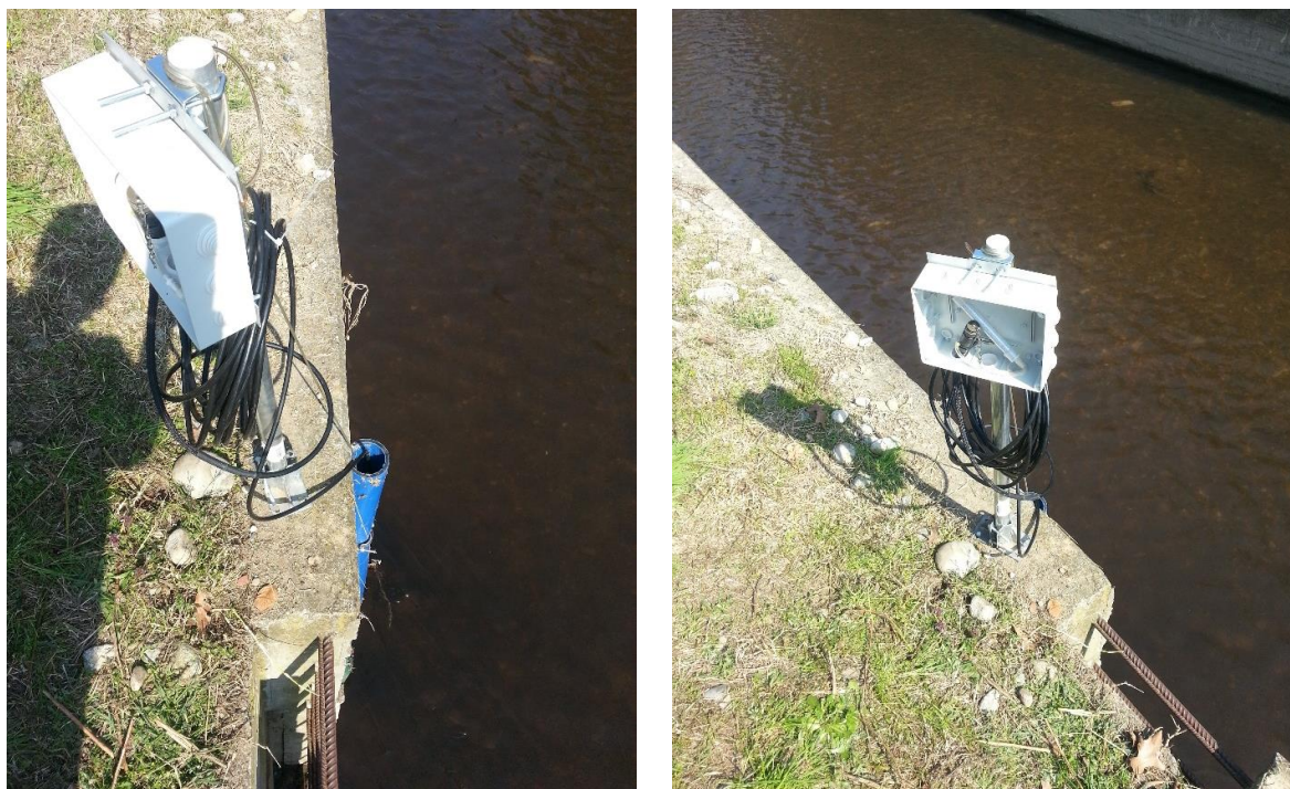
Figura 23 – Struttura di installazione della sonda multiparametrica
